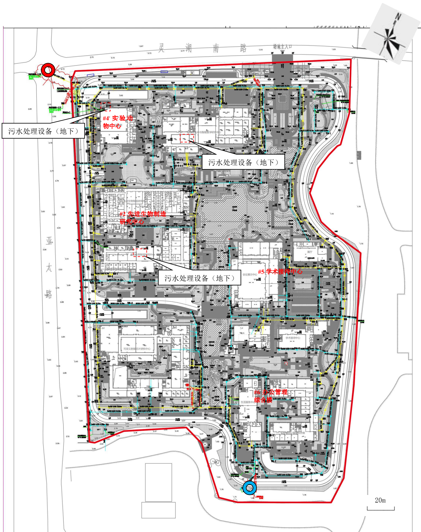
附图 6 厂区雨污管网图
