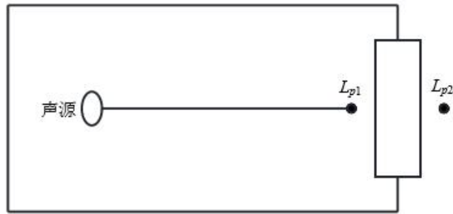
图 4-1 室内声源等效为室外声源图例
